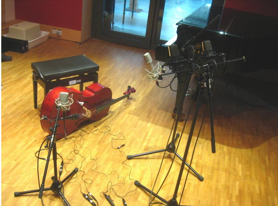
Der Einsatz von unterschiedlichen Mikrofonen hatte den Vorteil, dass das Signal sehr direkt aufgezeichnet werden konnte. Die Positionen der Kontaktmikrofone am Korpus führten dazu, dass unterschiedliche Frequenzbereiche des Spektrums genauer definiert werden konnten.
